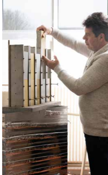
Qualification de revêtements, réalisée avec l'accélérateur Vulcain (EDF/CEMÉTÉ)
