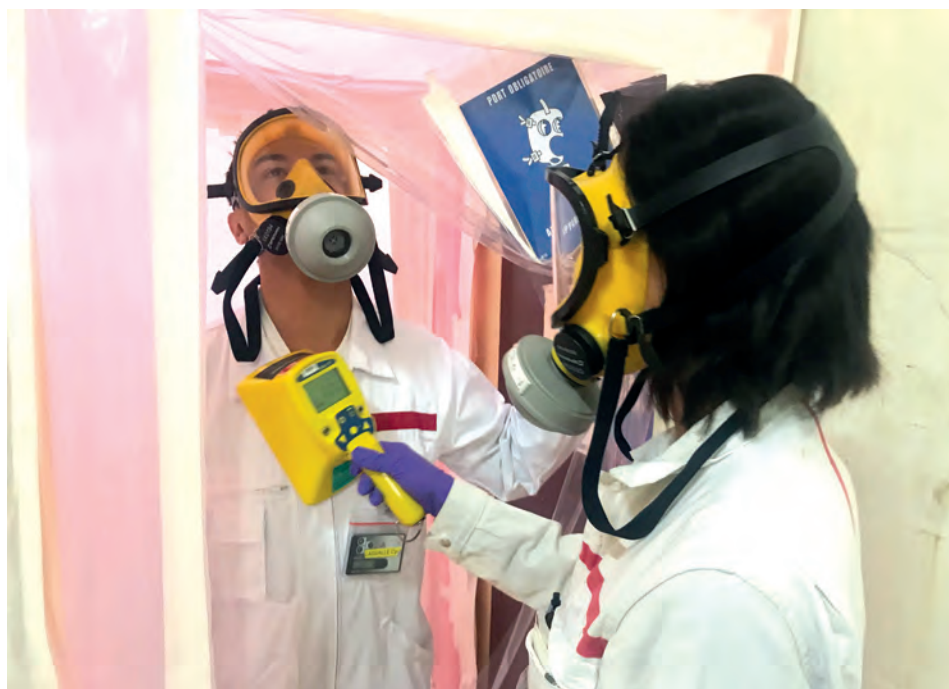
Un contrôle corps entier est effectué après chaque intervention en zone à risque.
