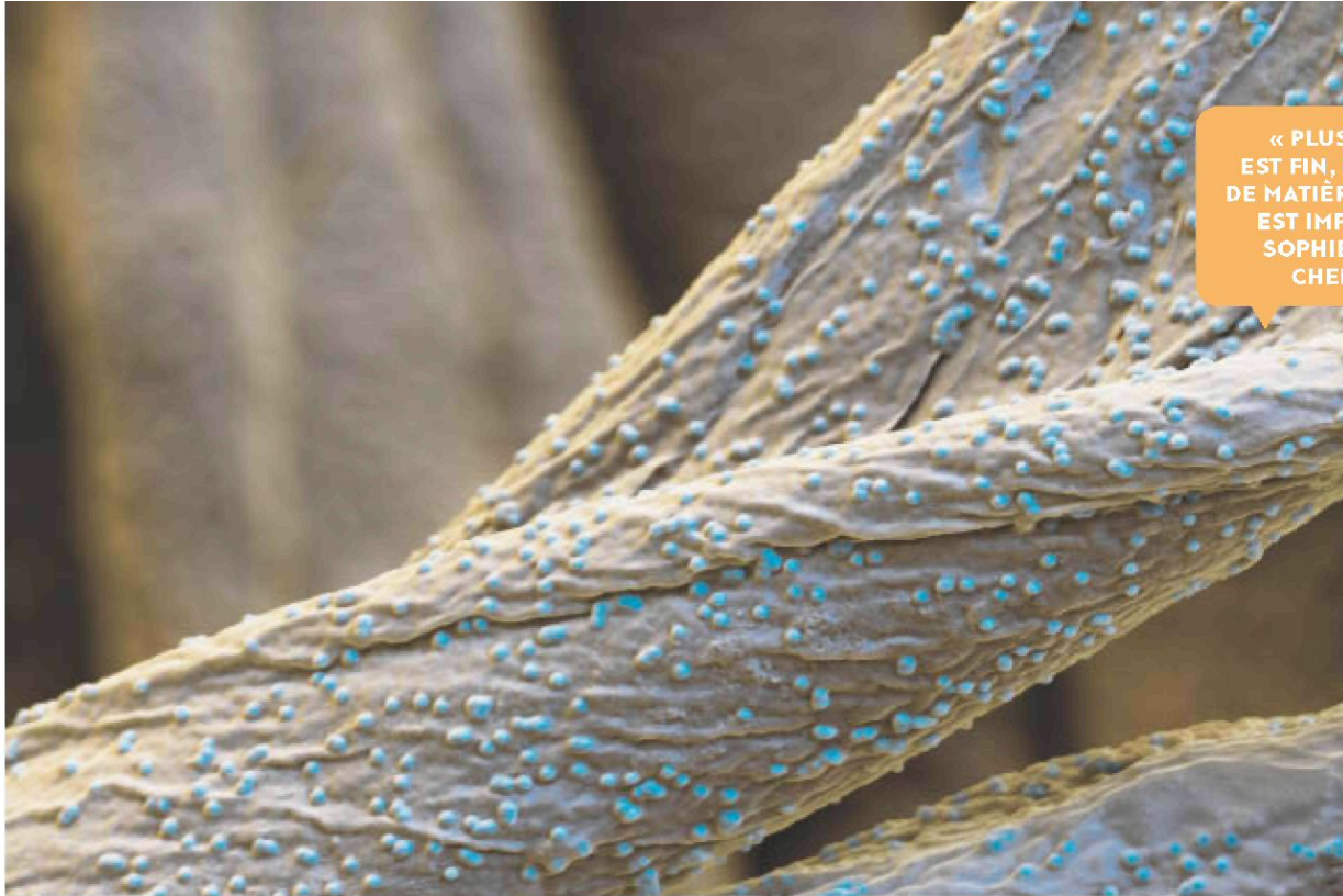
FIBRES DE COTON RECOUVERTES DE NANOPARTICULES DE POLYMÈRE RENDANT LE TISSU HYDROPHOBE ET ANTITACHES. PHOTO EYE OF SCIENCE/PHANIE
