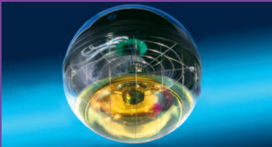
Module optique du détecteur de neutrinos Antares.
